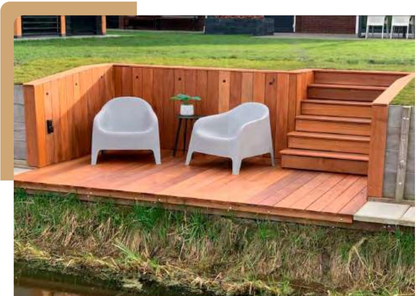
Bei Laubholzprodukten der Dauerhaftigkeitsklasse 1 kann ein gewisses Verziehen auftreten. Es besteht auch die Möglichkeit, dass Hartholz "ausblutet", was zu Verfärbungen angrenzender Materialien wie Beton oder Pflaster führen kann.
